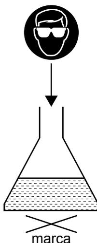
Se añadieron  $10,0\text{ cm}^3$  de ácido clorhídrico  $2,00\text{ mol dm}^{-3}$  a  $50,0\text{ cm}^3$  de solución de tiosulfato de sodio a la temperatura  $T_1$ . Los estudiantes midieron el tiempo que tarda la marca en desaparecer a simple vista. El experimento se repitió a diferentes concentraciones de tiosulfato de sodio.
